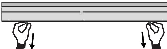
IT Inserire i fianchetti di chiusura; l'adesione avviene automaticamente mediante magneti.
